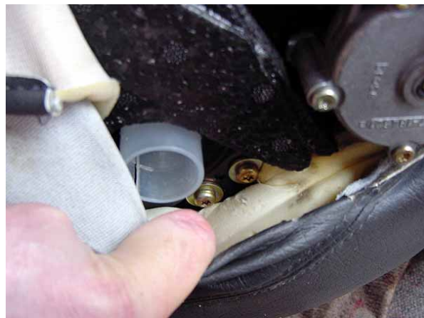
zwei Schrauben unterhalb der Handradachse.
